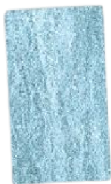
JM PROTEKTOR cynkowanie ogniowe 20 µm po 12 tygodniach
