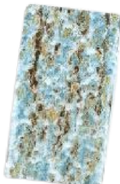
cynkowanie zanurzeniowe 85 µm po 12 tygodniach
