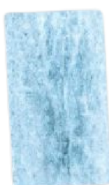
JM PROTEKTOR cynkowanie ogniowe 20 µm po 34 tygodniach
