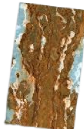
cynkowanie ogniowe 20 µm po 6 tygodniach
